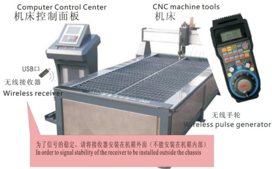
注意：为了信号的稳定，请将接收器安装在机箱外面（不能安装在机箱内部）
